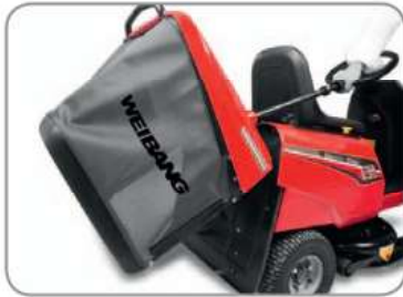
Einfache Fangkorbentleerung vom Fahrersitz aus
